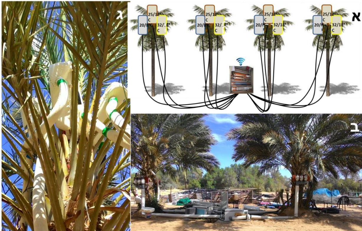
איור 1: 'פיטוטרונים מודולריים' - תאים מבוקרי אקלים הסובבים את התפרחות בעץ תמר בוגר. תיאור סכמטי (א) ומבט כולל על המערכת המחוברת לעצים (ב); התאים החובקים את התפרחות על העץ (ג).
