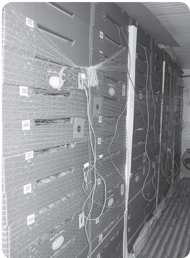
תמונה 3: תיבות אור עם החיווט של מערכת חישת הטמפרטורה, במכולת הקירור הניסיונית במפעלים ליצוא הדריס באשדוד. בתיבות הכחולות - הפרי המאולח בזבוב.
